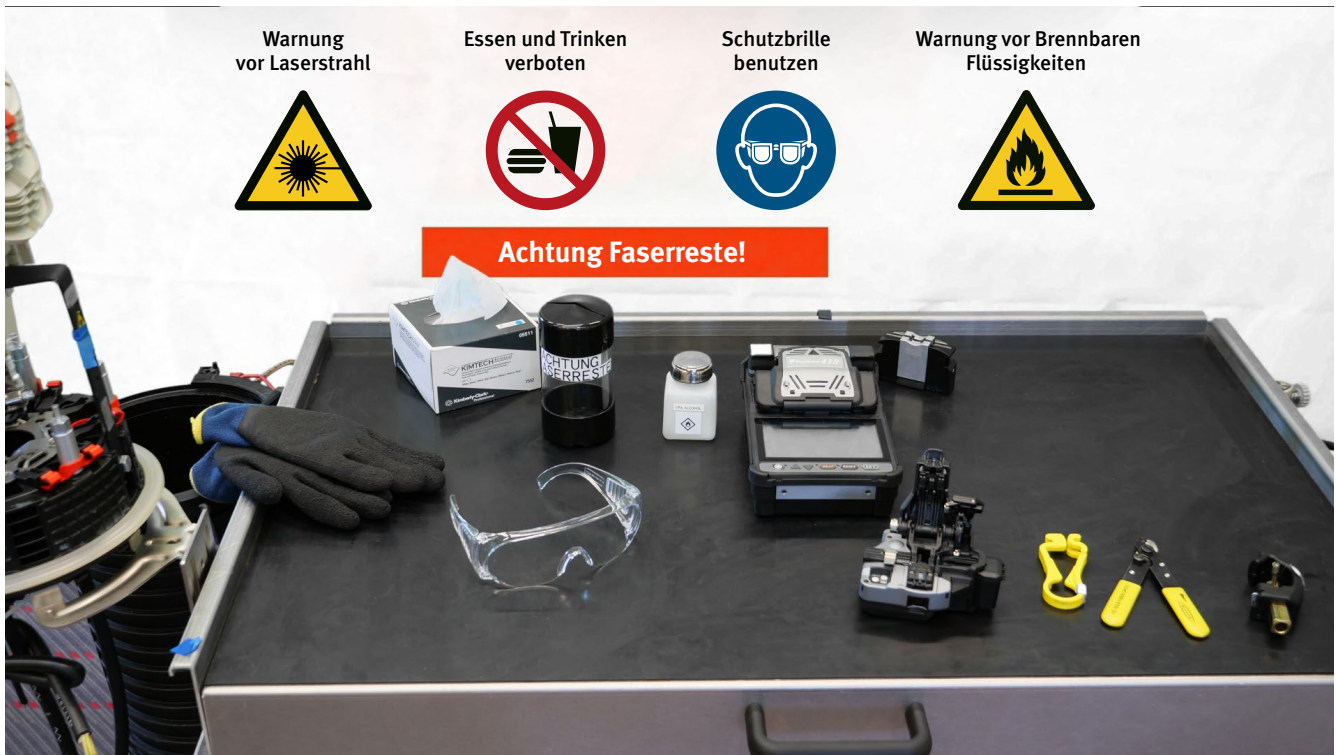
Abb. A3.15 Arbeitsplatz zum Herstellen eines mechanischen Spleißes (tragbarer Tisch für Außendienstmonteure)
